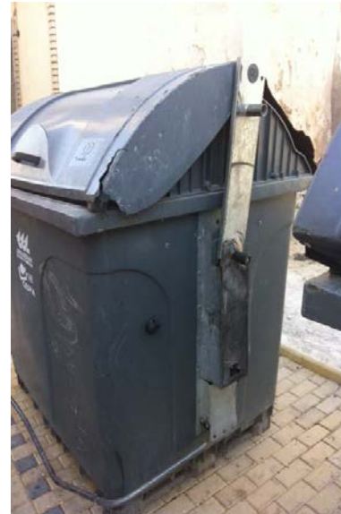
Imagen de Contenedor en mal estado de conservación con sistema de apertura roto.
